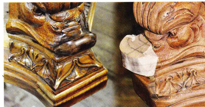
An einem Fischkopf fehlte der untere Teil des Mauls. Rechts wurde ein neues Stück angesetzt und links ist die fertige Schnitzerei zu sehen. Weiterhin fehlte hier das untere Profil, und man kann gut den Unterschied zwischen dem rohen Holz und dem mit Schellack überzogenen fertigen Stück sehen.
